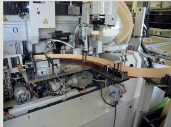
Das Beleimen dicker Werkstücke mit breiten Kanten ist eine der Stärken der Stream B, genauso wie die...
